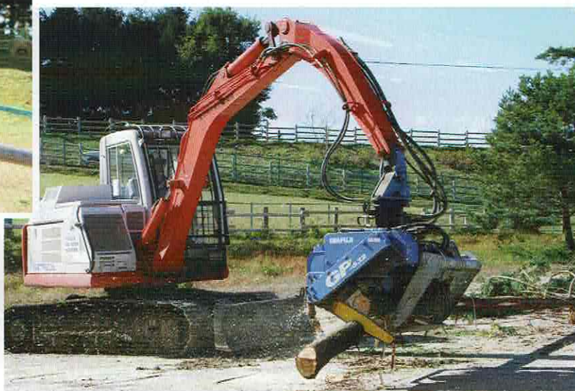
プロセッサ/枝払いと伐採木の輪切りする機械
